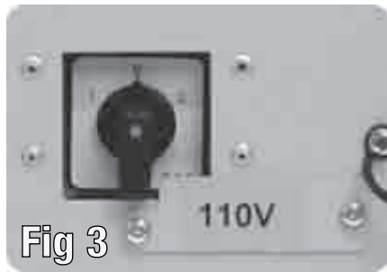
Fig 3 : Switch on machine via rotary switch. Position 0 : Off Position 1 : 230 volt. Position 2 : 110 volt.
